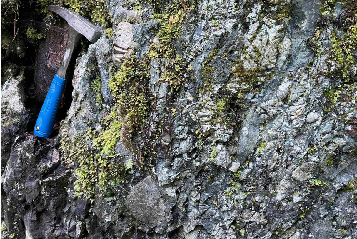
Foto 3-2: Grovere lag av sandsteinskonglomerat med klaster opp til 5 cm. Generelt er observert kornstørrelse på mm-skala. Bildet er tatt fra kartleggingslokalitet 43.2 ved ca. profil 11 000 (Kilde: Norconsult).
