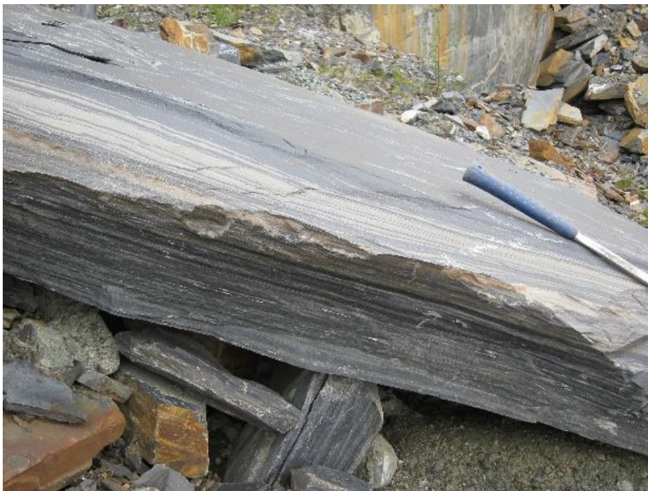
Foto 3-1: Rhyolittisk sandstein fra et steinbrudd øst for traséen ved ca. profil 10 300. Bildet viser tydelig laminert struktur i sandsteinen (Kilde: NGU).
